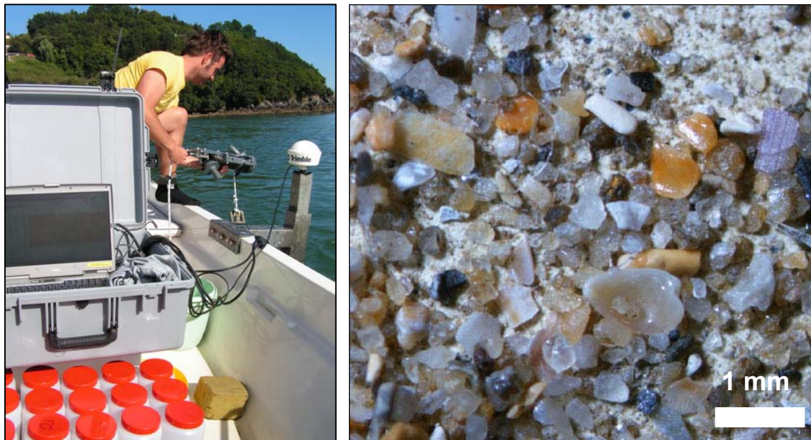
Figura 65. Toma de muestras de sedimento en suspensión y aspecto del sedimento recogido bajo la lupa binocular.
