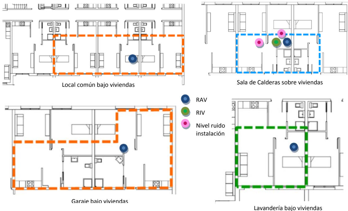
Figura 3: Ensayos realizados respecto a recintos de instalaciones y actividad
